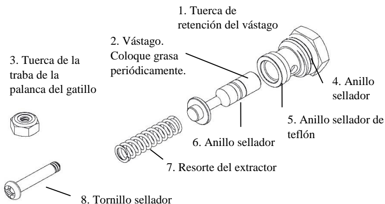
FIG. E: EQUIPO DE SUSTITUCIÓN DEL VÁSTAGO (48-064)
